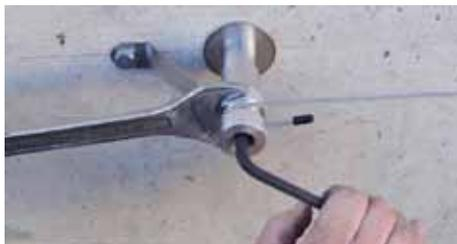
Produit 2 en 1 : une entretoise en aluminium anodisé servant de support aux câbles + tête rotative permettant d'enrouler le câble pour le tendre et le bloquer.
